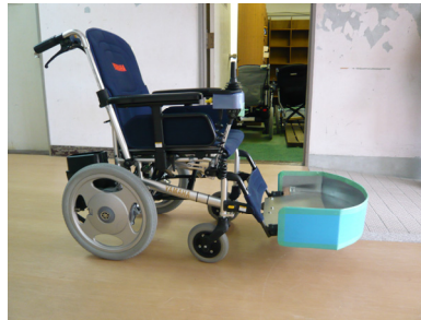
図5 フットガードを装着した 電動車椅子
