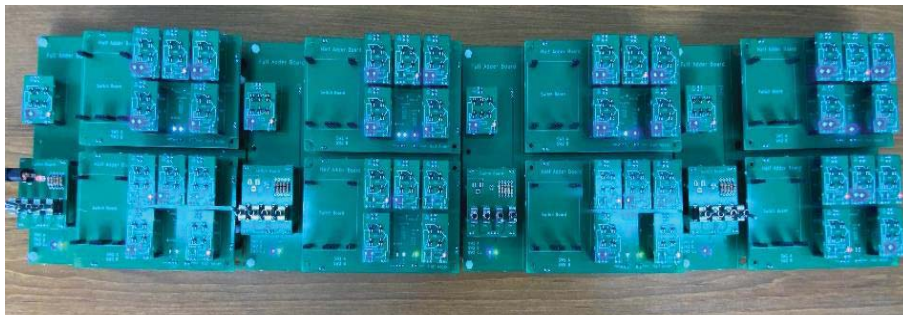
図 3 全加算回路基板による 4 ビット連結の例
