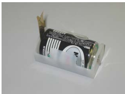
電池ケースの(Spring (マイナス側)の途中に黄銅板(電極、Y字型に切つてあるほうが上)をはさみながら電池を滑らせるように入れる。プラス側は後で入れる。
