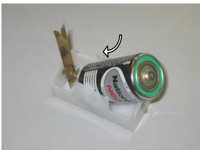
電池ケースの(Spring (マイナス側)の途中に黄銅板(電極、Y字型に切つてあるほうが上)をはさみながら電池を滑らせるように入れる。プラス側は後で入れる。
