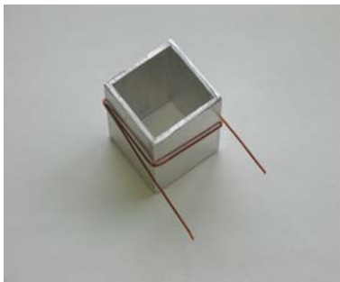
最初は短いほうの電線を使う。巻き枠を使って写真のように巻き、両端を3 cmのこす。
