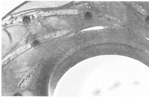
(a) 吸込リングを羽根車に取付けた場合
