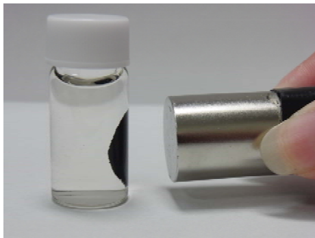
水中で磁力に反応する吸着剤
